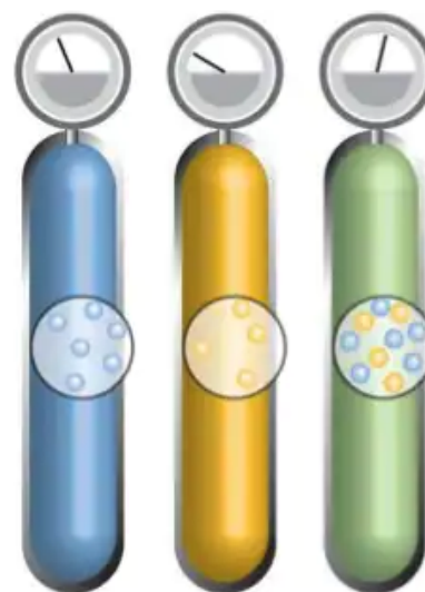
Figura 12: Mistura de Gases, com base na teoria de Dalton
