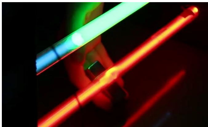
Figura 26: desvio do gás dentro do tubo utilizando um ímã.
