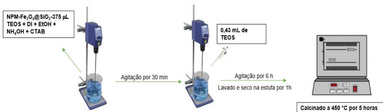
Figura 13. Esquema para a síntese do revestimento de sílica mesoporosa na nanopartícula magnética.
