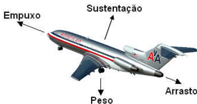
Figura 35 – As quatro forças envolvidas na Física do vôo dos aviões.
