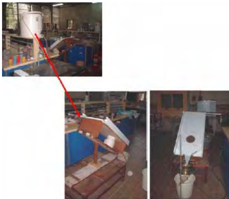
Figura 2.7 - Esquema do equipamento modelo “Inderbitzen” para investigação da erodibilidade do solo (Vilela, 2003).
