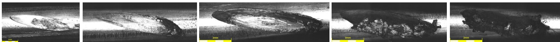
Figura A. 5 – Marcas de contato nos fios da camada intermediária. Grampo: Metálico com armadura. Condutor: CA 1120. Posição: Topo
