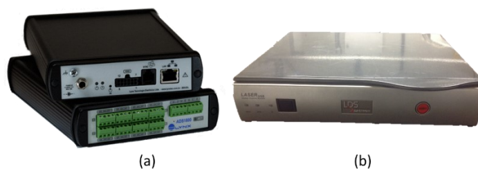
Figura 3.7 – (a) Sistema de aquisição de sinais, ADS 1800. (b) Controlador de vibração, LDS LASERUSB.
