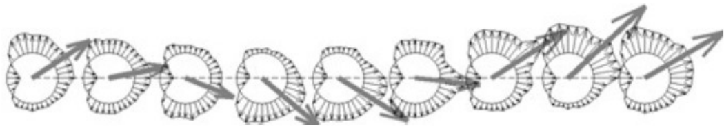
Figura 2.2 – Distribuição de pressão e modulo da força em nove momentos do desprendimento de vórtices (ZASSO et al., 2008).
