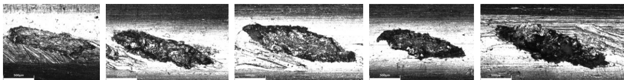
Figura A. 11 – Marcas de contato nos fios da camada intermediária. Grampo: Elastomérico. Condutor: CAL 6201. Posição: Topo
