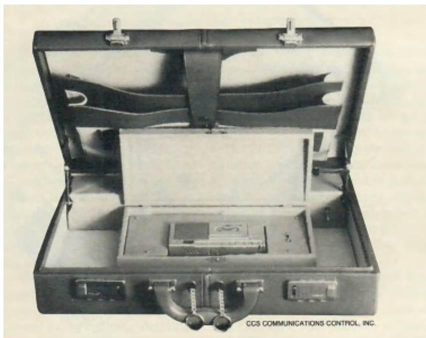
Figura 58. Gravador de fita oculto numa pasta que pode ser operado sem o conhecimento das pessoas que estão no mesmo ambiente do dispositivo.
