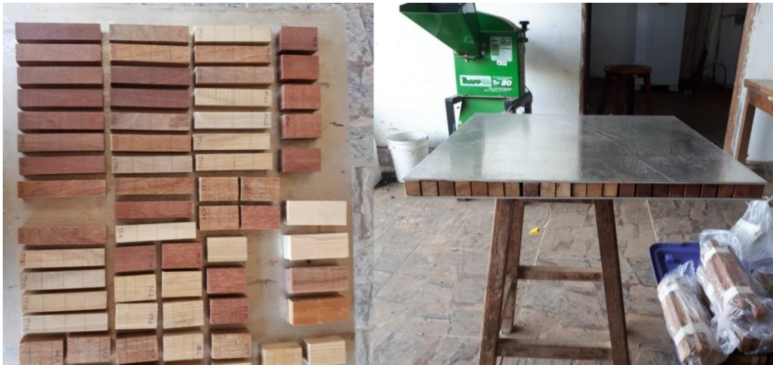
Figura 5.5. Amostras entre os pratos metálicos para ensaio com a prensa hidráulica.
