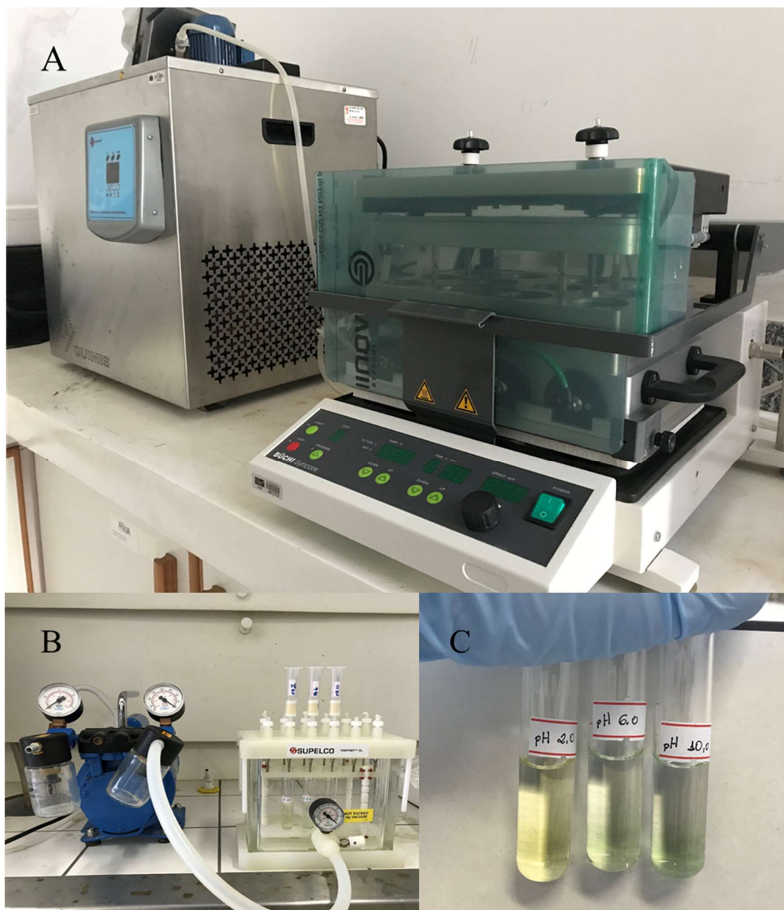
Figura 2.6. Evaporador paralelo (A); sistema utilizado para eluição das substâncias presentes nos cartuchos de SPE (B), e aspecto dos extratos (C).
