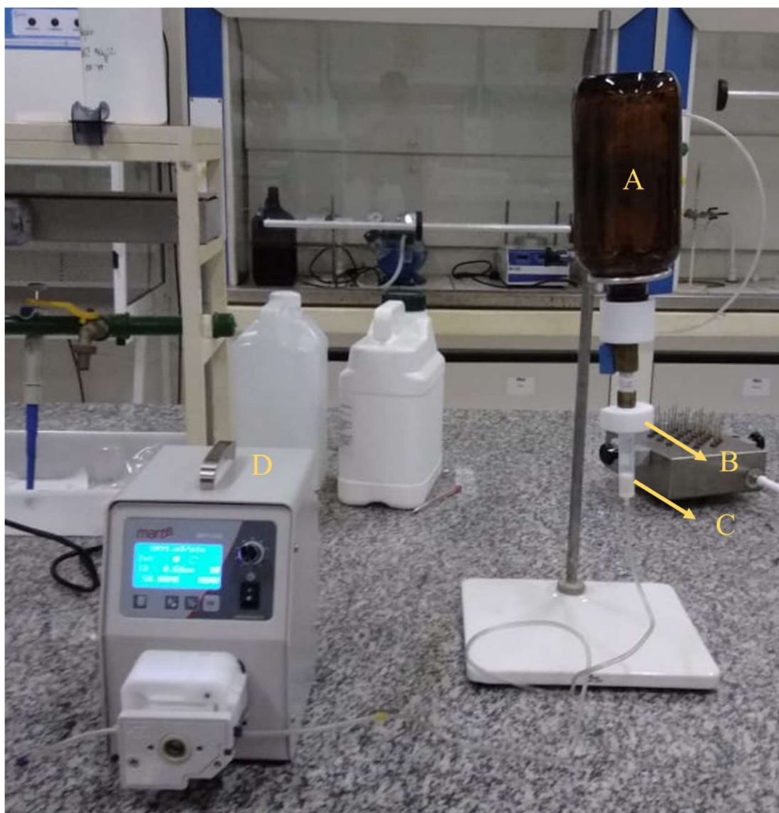
Figura 2.5. Sistema de extração utilizado. Em A, garrafa contendo amostra, B = peça confeccionada em PTFE para controle de fluxo e pressão, C = cartucho de SPE, D = bomba peristáltica multicanal.
