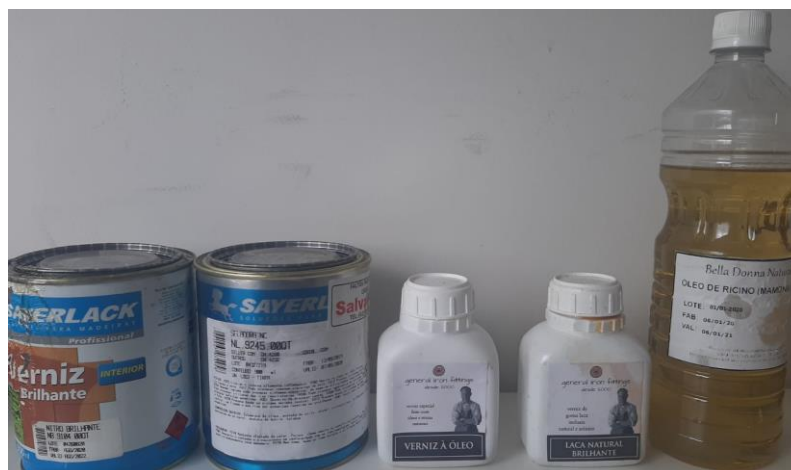
Figura 2 - Produtos utilizados para o acabamento da madeira. Da esquerda para direita: Verniz Brilhante, Seladora, Verniz à óleo, Laca Natural Brilhante e Óleo de mamona.
