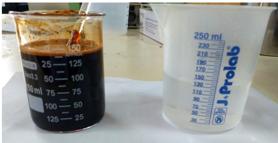
Figura 8: Soluções adesivas prontas para uso. Ácido cítrico/tanino (2:1) (AC/T) à esquerda e ácido cítrico puro (AC) à direita. Fonte: a autora.
