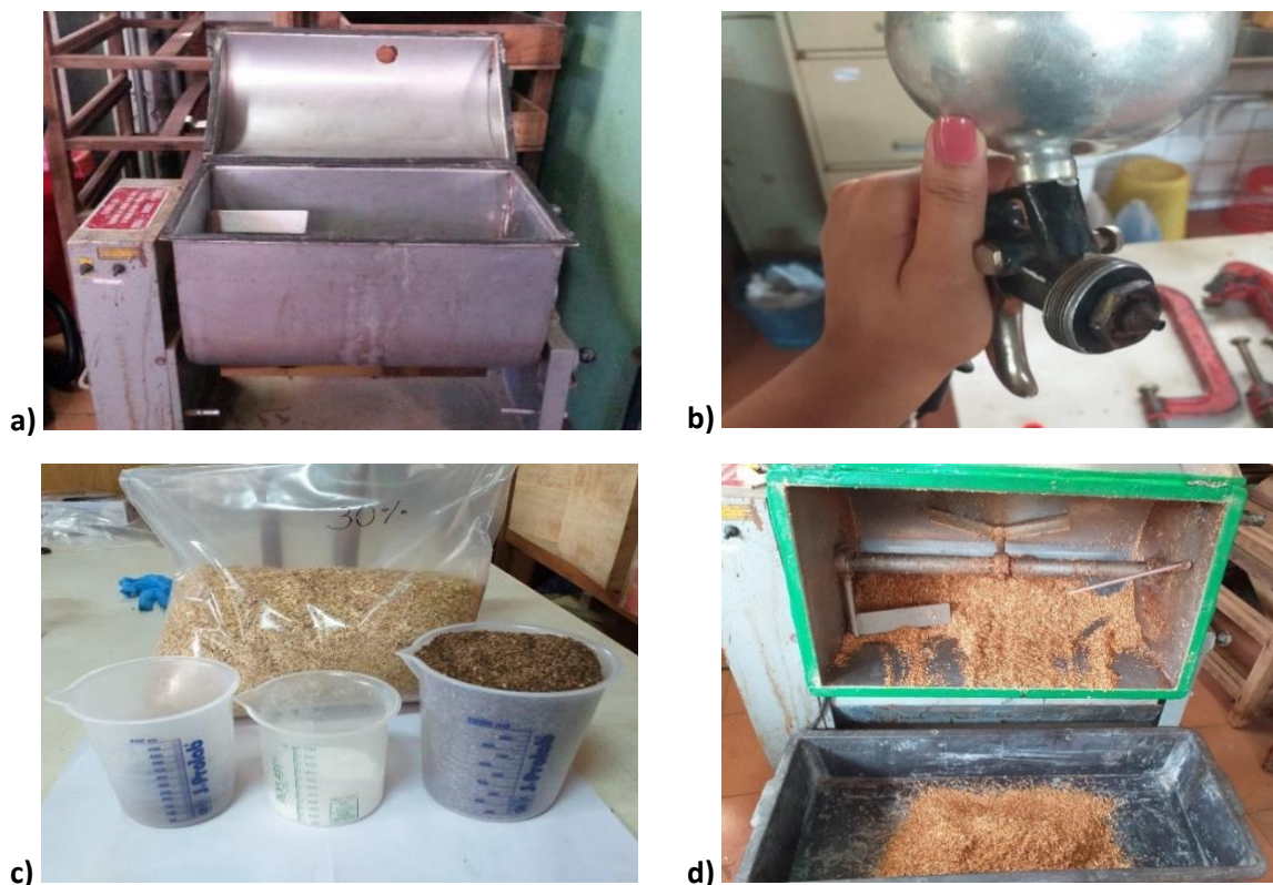
Figura 9: Etapa de mistura dos adesivos com as partículas a) Misturador de massas adaptado para mistura de partículas; b) Pistola de ar pulverizadora; c) Partículas de Pinus, partículas de Cacau e adesivos utilizada na confecção de um dos painéis; d) Partículas após mistura sendo retiradas para secagem.
