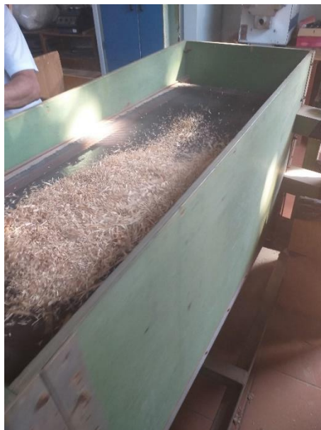
Figura 7: Classificadora do Galpão de Produtos do LPF. Fonte: a autora.
