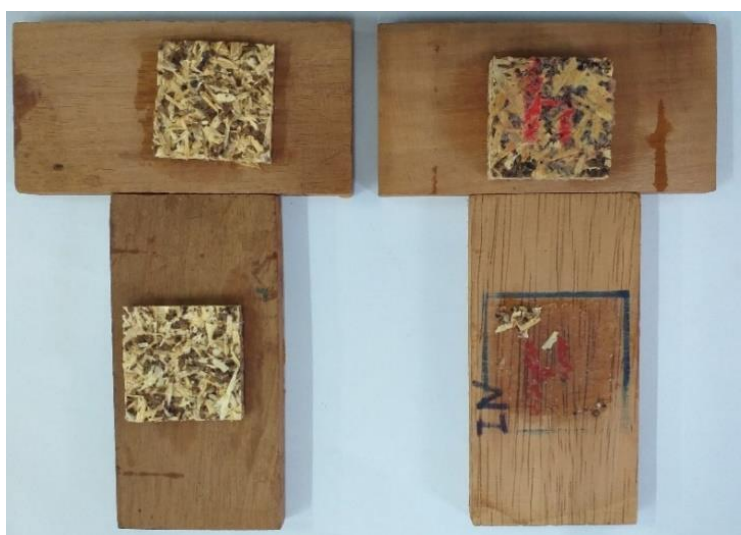
Figura 31: Corpos de prova após ensaio de TP. À esquerda rompimento no meio do corpo de prova. À direita rompimento na linha de cola. Fonte: a autora.
