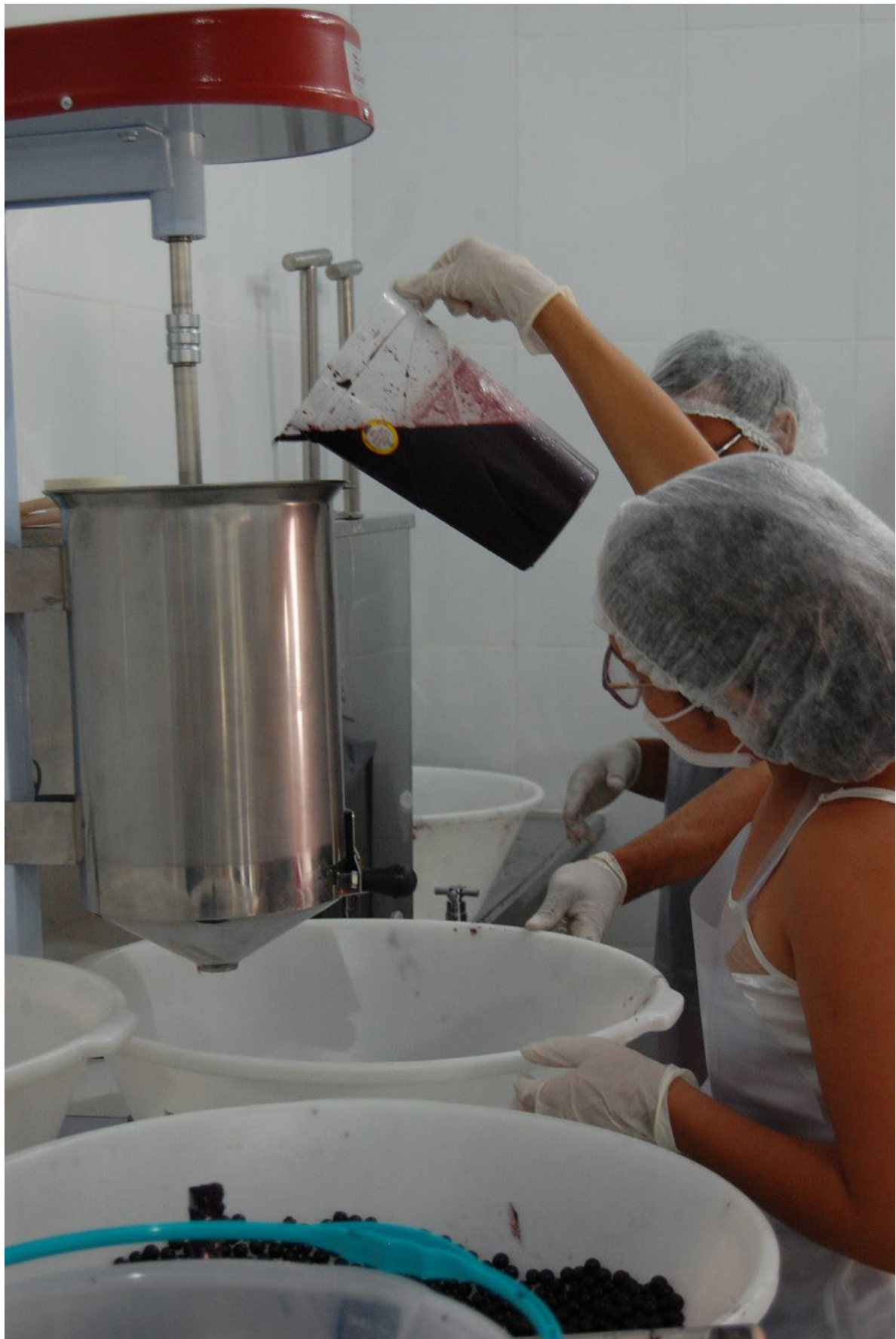
Figura 31. Diluição do açaí com água e processado em bateadeiras industriais.
