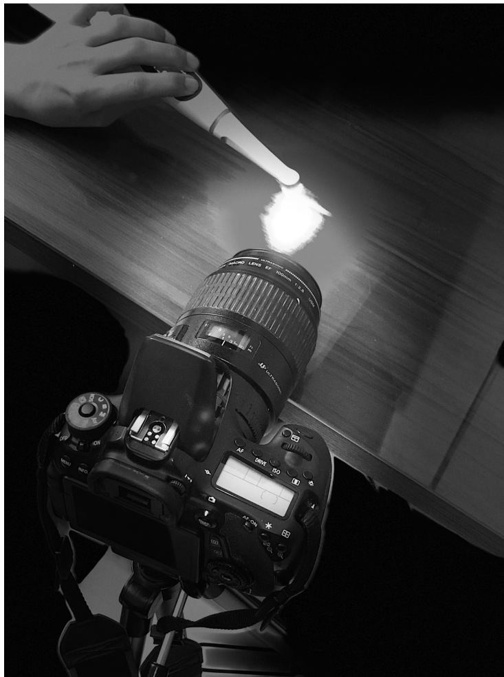
Figura 2: Câmera posicionada para capturar a passagem de luz através do pino
