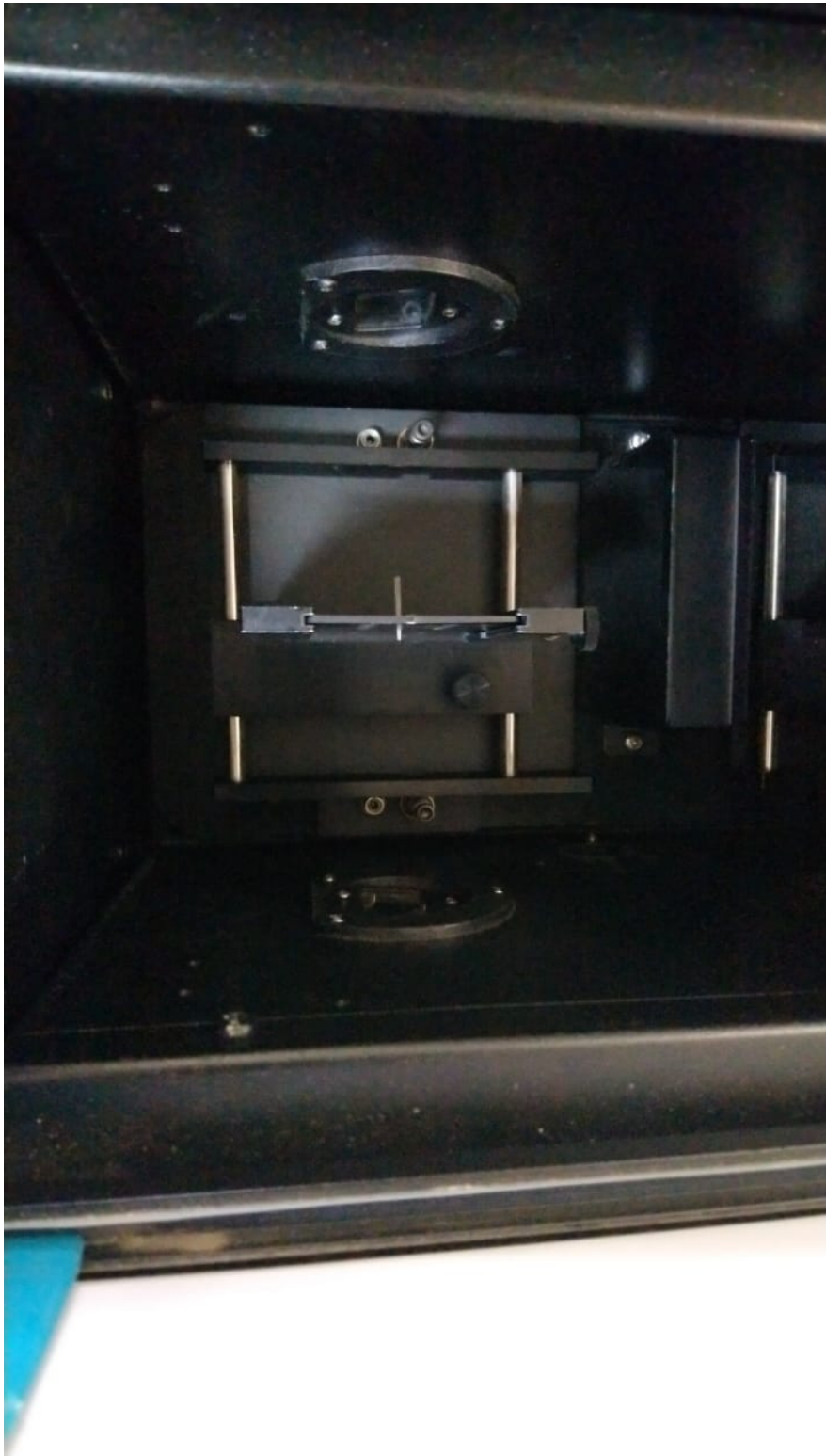
Figura 5: Pino posicionado dentro do Espectrofotômetro Ultravioleta Visível e Infravermelho próximo (UV-Vis- NIR), modelo Cary 5000, Varian
