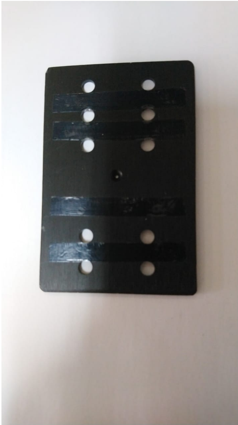
Figura 6: Anteparo utilizado para posicionar o pino dentro do equipamento
