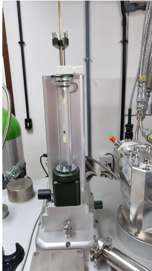
Figura 9: Equipamento SQUID e uma amostra inserida (Fonte: Gomide, G. 2022).
