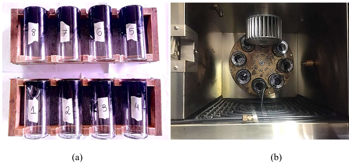
Figura 3.3 – Ensaio de RTFOT: a) preparação das amostras; b) ensaio em execução
