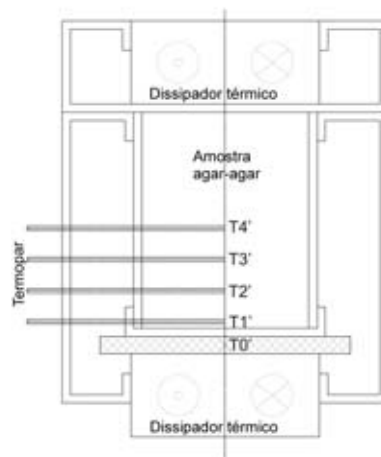
Figura 5.2: Detalhe do posicionamento dos termopares.
