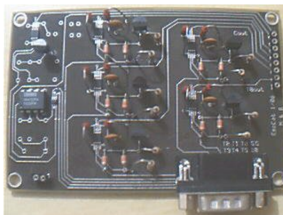
Figura 4.3: Placa de acondicionamento e amplificação de sinais.
