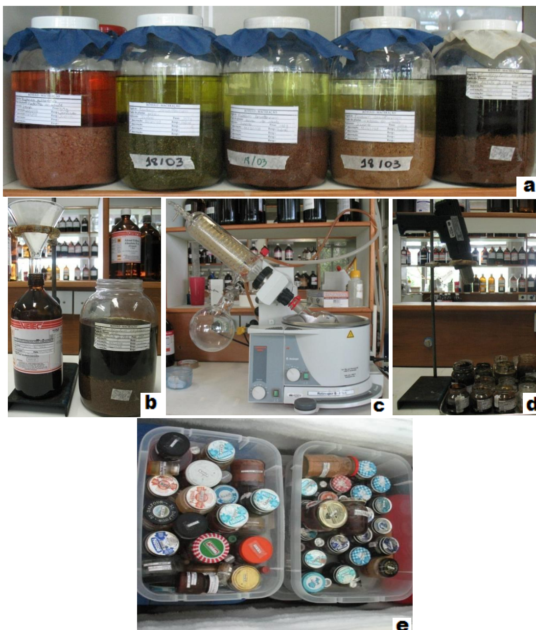
Figura 22 – Processo de extração por maceração, (b) Filtração para a obtenção da solução da solução extrativa, (c) Concentração em rota-evaporador, (d) Dessecação em soprador térmico e (e) Armazenamento do extrato bruto a -20 °C.
