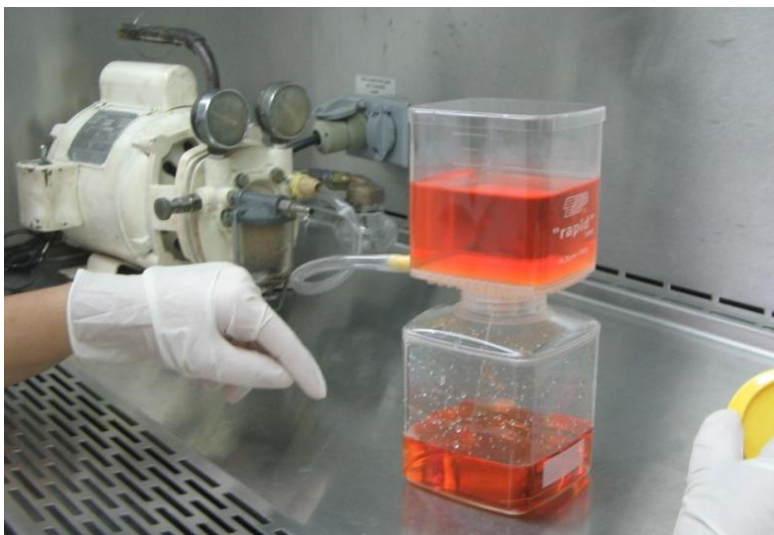
Figura 32 – Filtração do meio RPMI 1640 tamponado com MOPS em um sistema à vácuo, com poro de membrana de 0,22 \mu\text{m}
