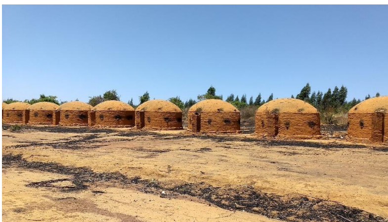
Figura 4.10. Fornos tipo rabo-quente para produção de carvão de eucalipto no município de São João do Paraíso, Minas Gerais (Território Alto Rio Pardo). Fonte: próprio autor.
