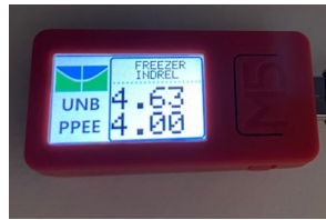
Figura 5.5: M5 Stick-c lendo os dados, armazenando e mostrando no LCD Fonte: Próprio autor.
