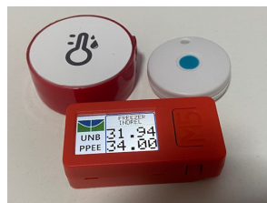
Figura 5.6: Dois sensores de fabricantes distintos sendo lidos simultaneamente pelo M5 Stick-C Fonte: Próprio autor.
