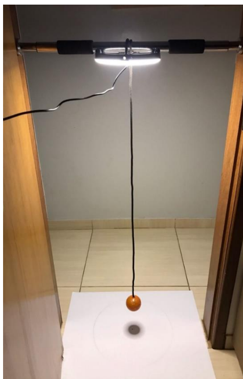
Figura 18 - Pêndulo Cônico constituído por um corpo de massa m preso a um ponto fixo por um fio de comprimento conhecido
