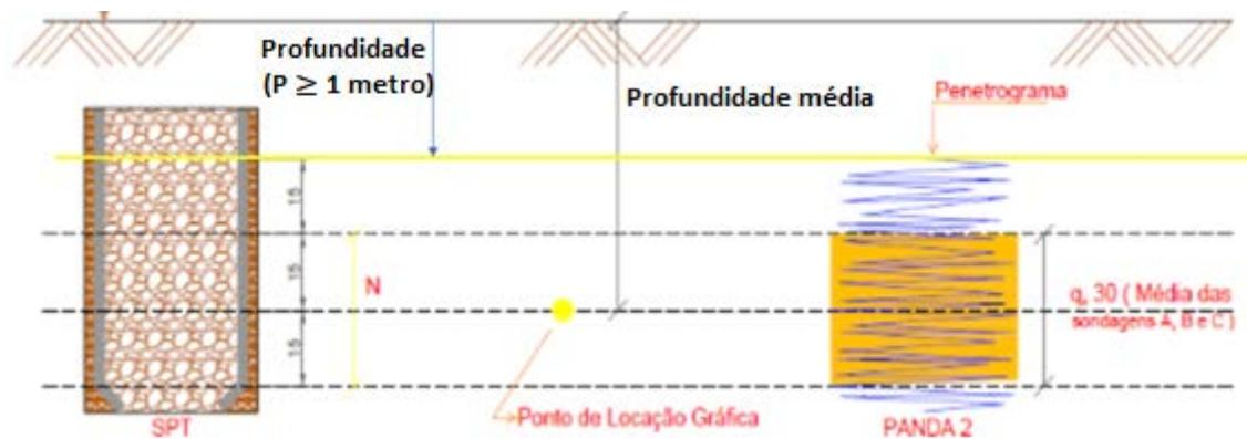
**Figura 5.10:** Esquema dos ensaios SPT e PANDA 2 e seus parâmetros para comparação.
