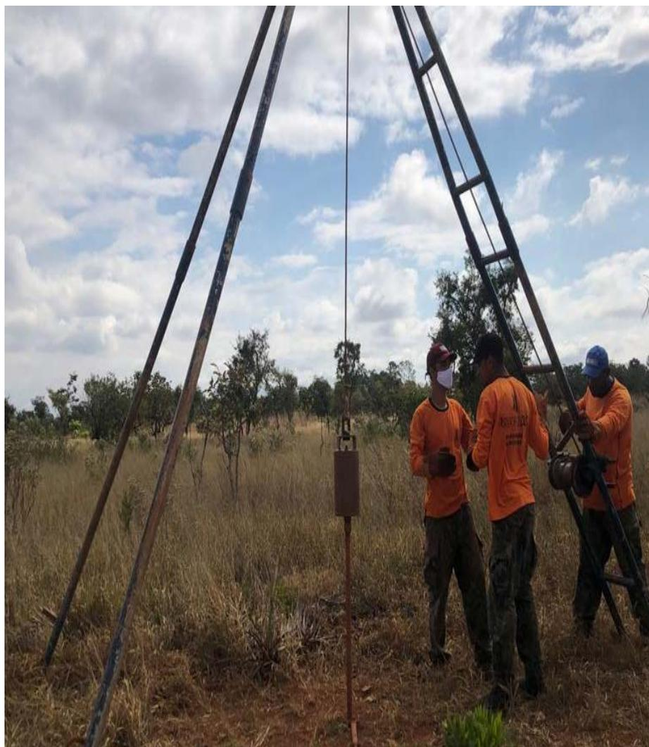
**Figura 4.6:** Execução dos furos de sondagem SPT.
