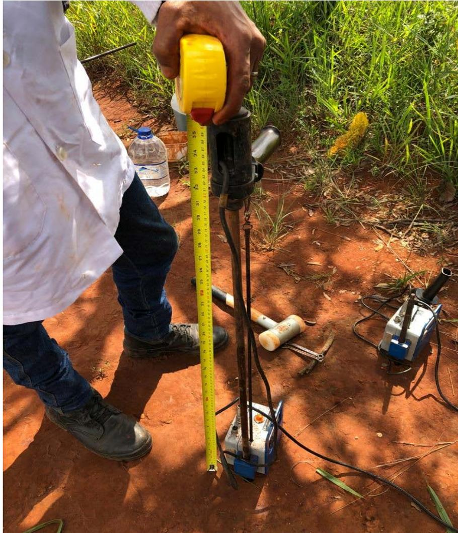
**Figura 4.4:** Execução de um dos furos de sondagem com o equipamento PANDA 2
