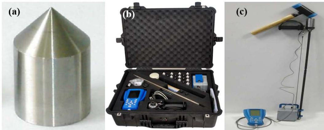
**Figura 2.4** (a): Cone de 4 cm<sup>2</sup> (b) Maleta com o Equipamento PANDA 2 (c) PANDA 2 Montado
