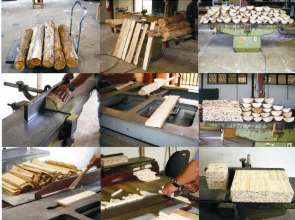
Figura 3.4: Seqüência de desdobro do eucalipto do formato de toretes até o formato definitivo dos corpos de prova.
