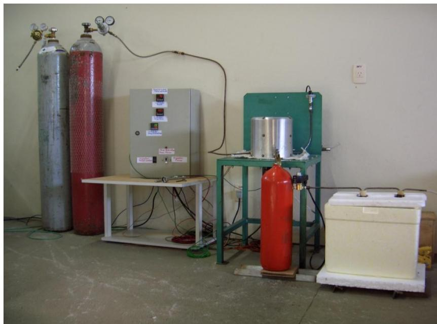
Figura 3.3: Vista geral do reator de PSP desenvolvido no SFB: Fonte de nitrogênio, reator montado na mesa, conexões de gás e eletroválvula.
