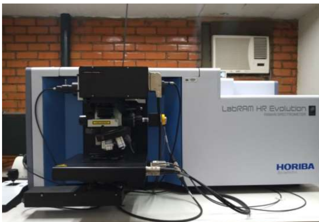
Figura 8: Espectrômetro Raman (LabRam Evolution) utilizado para coleta dos espectros em impressões digitais latentes.
