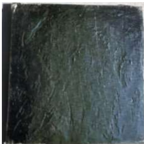
Figura 7: Substrato de vidro revestido de alumínio utilizado para deposição do dedo de cada doador.
