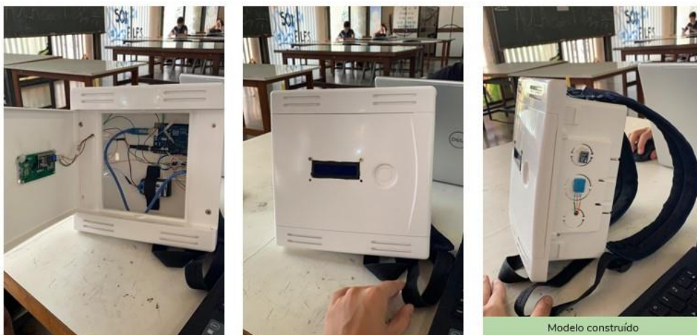
Figura 2 – Primeiro protótipo construído com quadro de distribuição.
