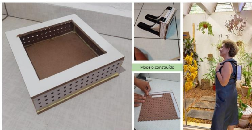
Figura 3 – Modelo de abrigo construído com MDF.
