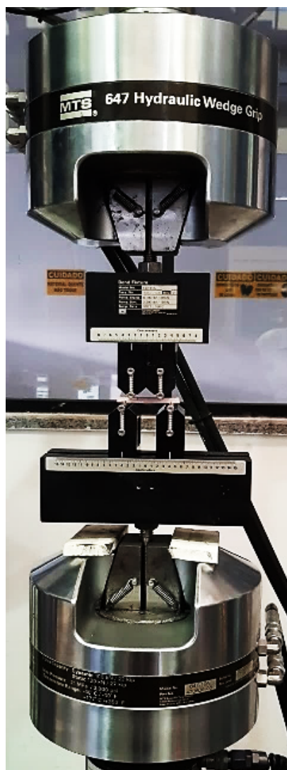
Figura 24 - Equipamento para ensaio de flexão de 4 pontos.
