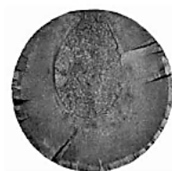
(b) Superfície de fratura por fadiga de um eixo de locomotiva (adaptado de Colpaert, 1969)
