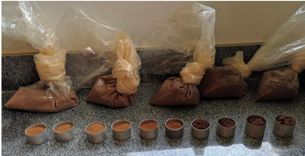
Figura 3.8 – Amostras para o ensaio MCT com diferentes teores de umidade. Da esquerda para a direita: solo menos úmido para mais úmido.
