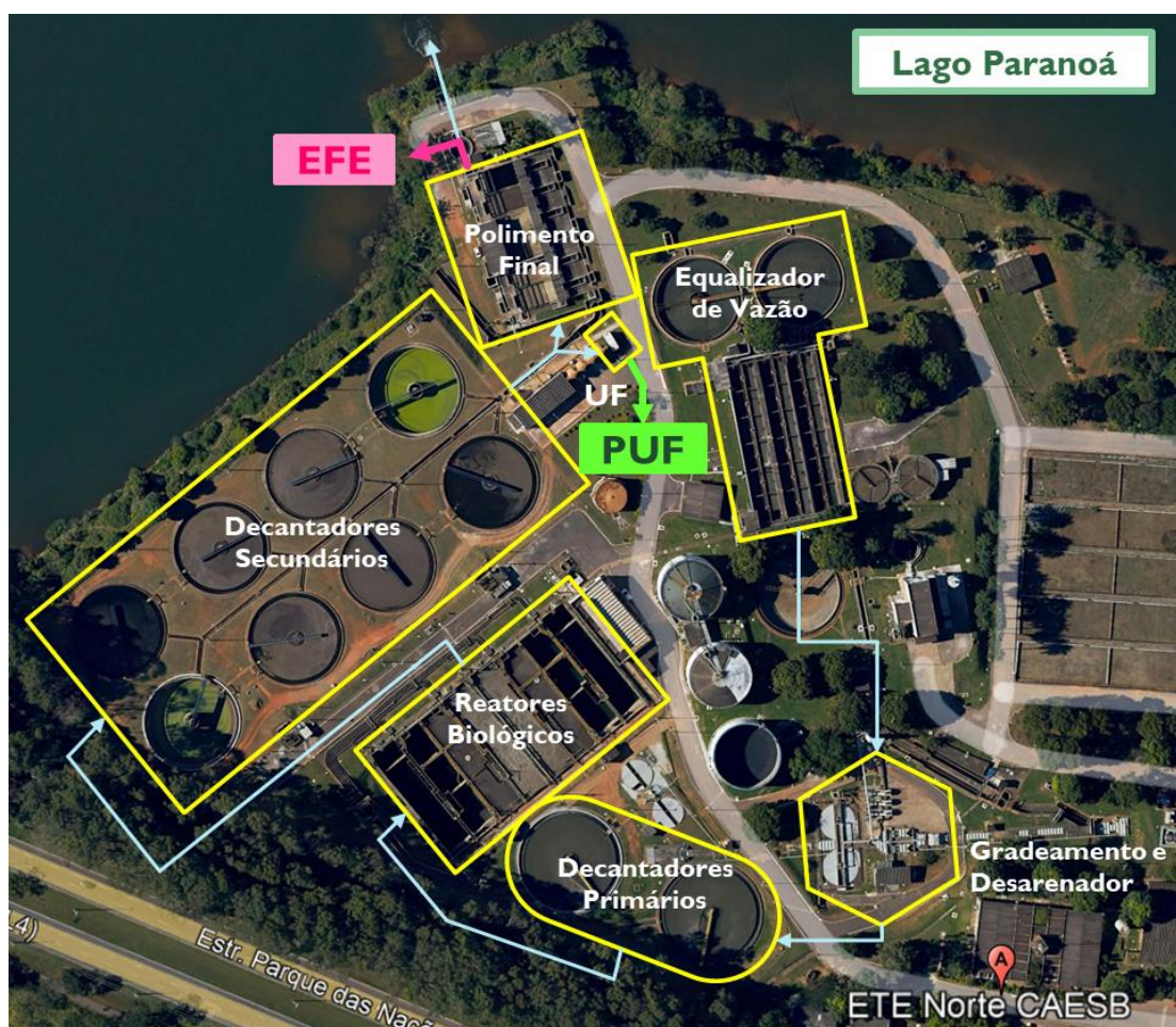
Figura 4.1 – Estação de Tratamento de Esgoto Brasília Norte com suas etapas de tratamento e com pontos de coleta das matrizes de alimentação PUF (retângulo verde) e EFE (retângulo rosa).
