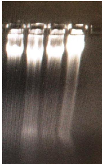
Figura 26 - Gel de agarose das amostras de lodo (da esq para a direita): PS, SS, TS, lodo digerido
