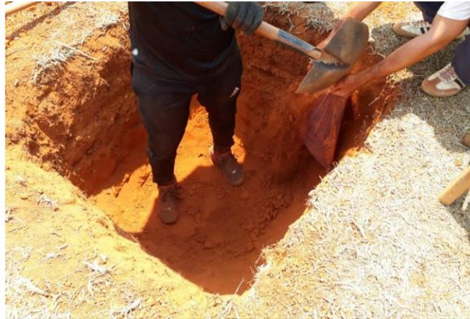
Figura 3.2 – Poço a 1 m de profundidade, solo profundamente intemperizado.
