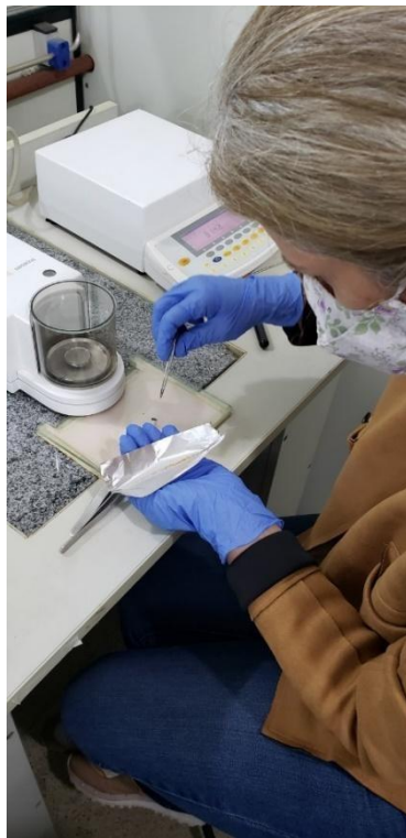
Figura 14: Fotografia do preenchimento do copo de estanho para pesagem.
