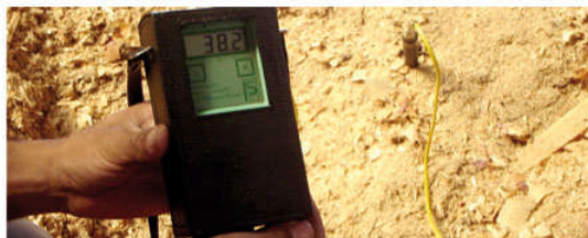
A9 - Medindo temperatura da serragem
