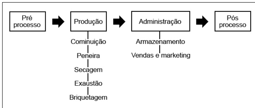
Figura 2.1- Fluxo de massa em uma indústria de briquete de madeira
