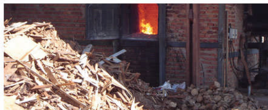
C8 - Retalhos a queimar na fornalha
