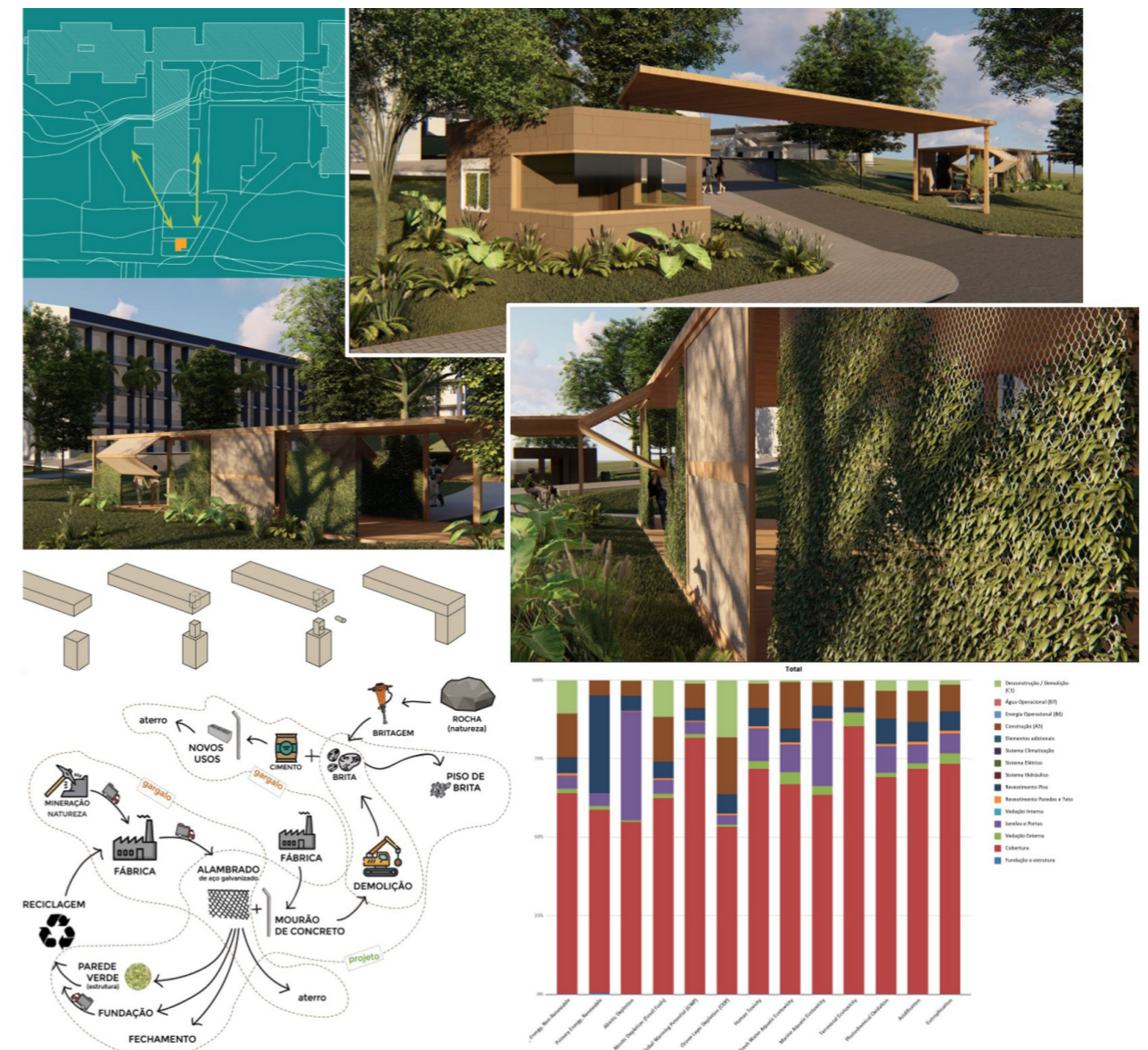
Figura 5: Entrega do desafio de design circular: projeto do equipamento, conceito de desmontagem, mapeamento de sistema e gargalos de circularidade, e análise por ACV.
