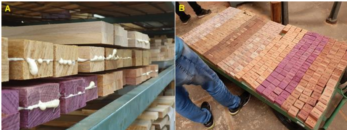
Figura 16. Blocos colados e armazenados na sala de climatização para dar origem aos CPs (A) e CPs sendo identificados para iniciar o teste CLC.
