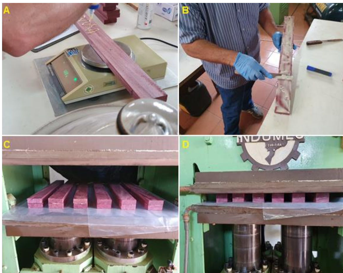
Figura 15. Aplicação do adesivo com auxílio da balança de precisão para alcançar a gramatura de 200 g/m 2 (A) e a distribuição do adesivo na área da lamela a ser colada com auxílio de uma espátula (B), preparação dos blocos para prensagem (C) e blocos submetidos a prensagem pelo tempo de 2 horas (D).
