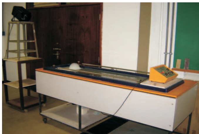
Figura 3.4: Vista lateral da bancada de visualização de escoamento para a execução dos experimentos do projeto com as geometrias aerodinâmicas.
