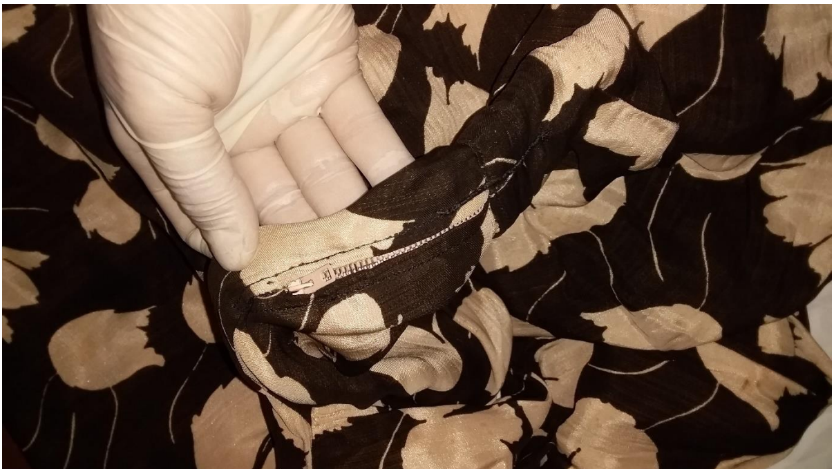
Figura 65: Costura do zíper a mão. Fonte: Márcia Pinheiro Ferreira, 2020.
