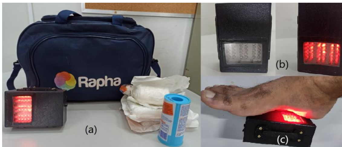
Figura 1. Sistema terapêutico para neof ormação tecidual RAPHHA®. (a) O kit fornecido a cada participante do estudo; (b) Dispositivo RAPHHA®; (c) Exemplo de uso do dispositivo. Fonte: Autor.
