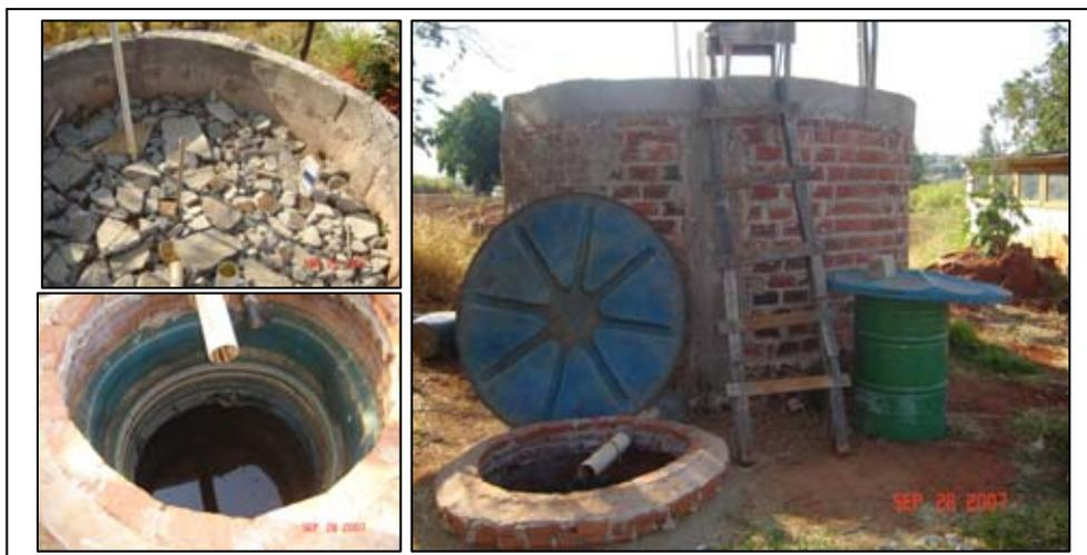
Figura 4-8. Lisímetro experimental
