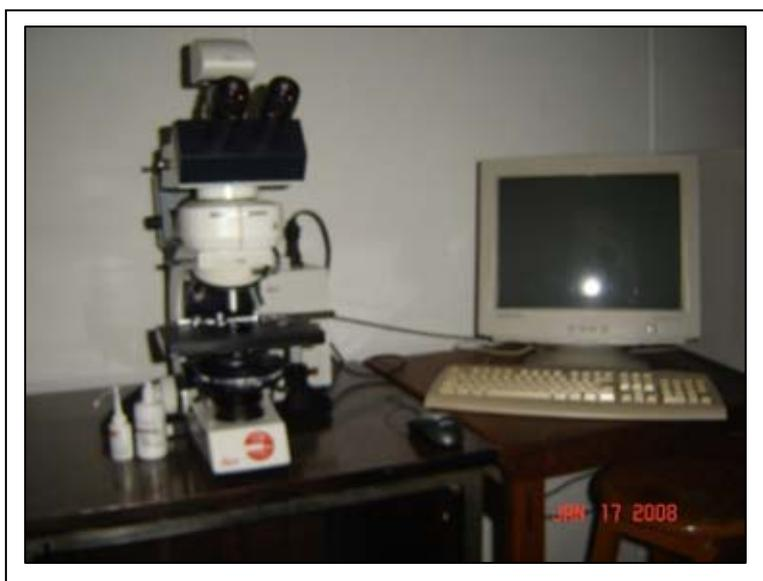
Figura 4-10. Sistema de aquisição de imagens para realização de microscopia das morfologias presentes no onóculo e licor misto do RBS<sub>AN</sub>
