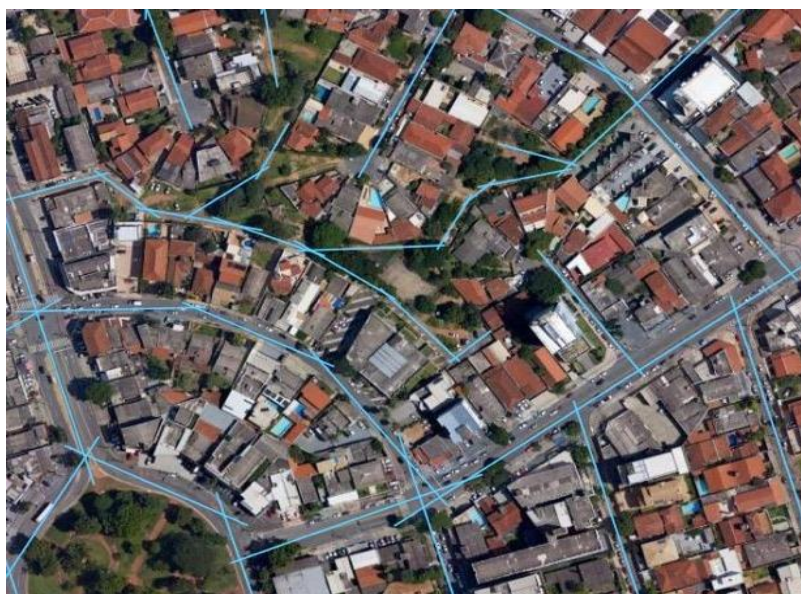
Figura 27 - Processo de construção dos eixos na base cartográfica inicial, realizado no QGIS©.
