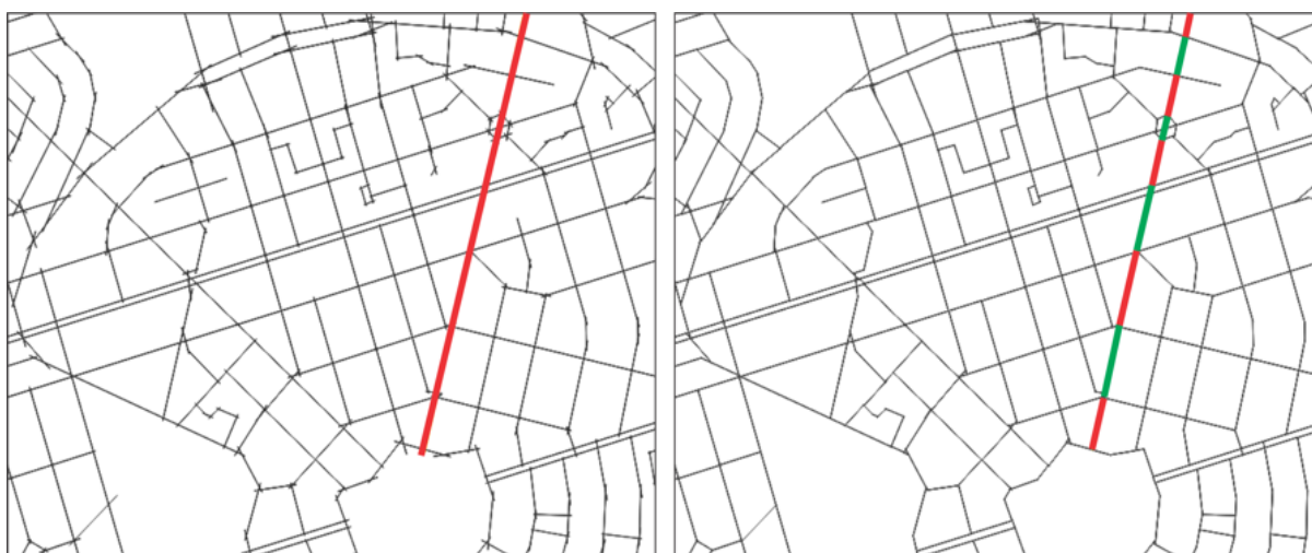
Figura 28 - Mapas axial (à esquerda) e de segmentos (à direita), com a representação de uma via como eixo contínuo e fracionado (cada segmento ilustrado com cores alternadas) no encontro com outros eixos, respectivamente
