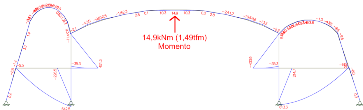
Figura 87: Diagrama de momento da superfície NURBS no Ftool com perfil T101,6x6,3 (Fonte: Autora).
