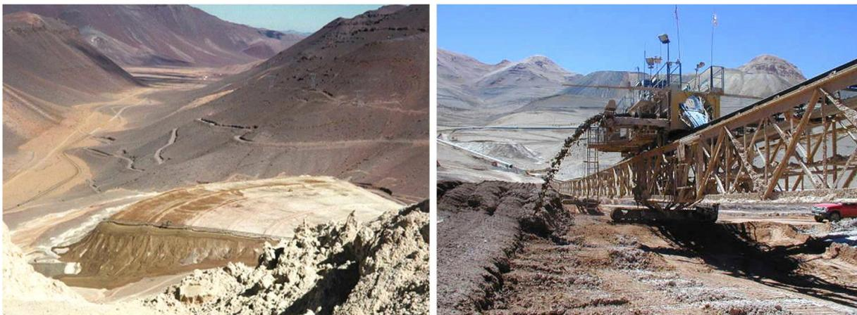
Figura 2.10 – Pilha de rejeito filtrado (Dixon-Hardy et al., 2007).
