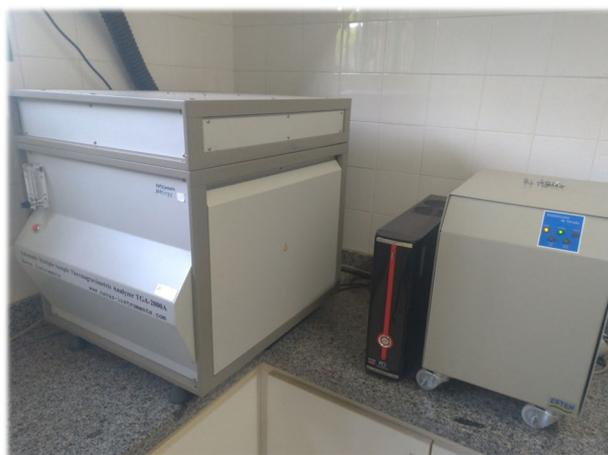
Figura 9 - Equipamento de Termogravimetria *Navas Instruments*, modelo TGA-2000A (LPF – SFB)
