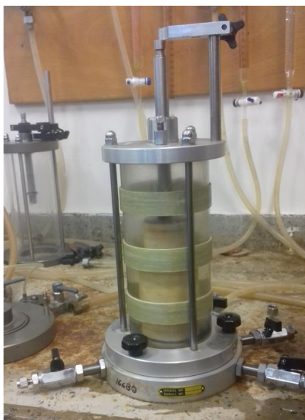
Figura 3.42: Montagem final da célula de adensamento
