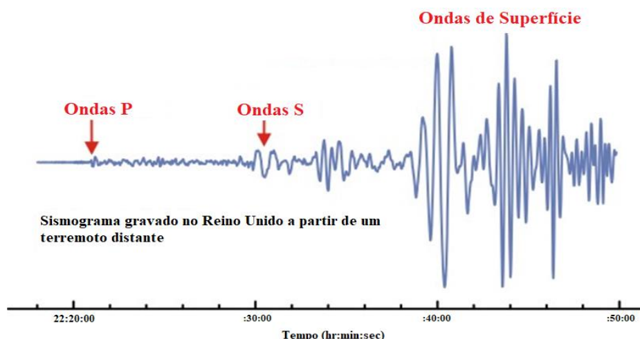
Figura 2.22: Identificação das ondas de corpo e superficiais em um registro sísmico de terremoto (modificado de Rocha, 2020)
