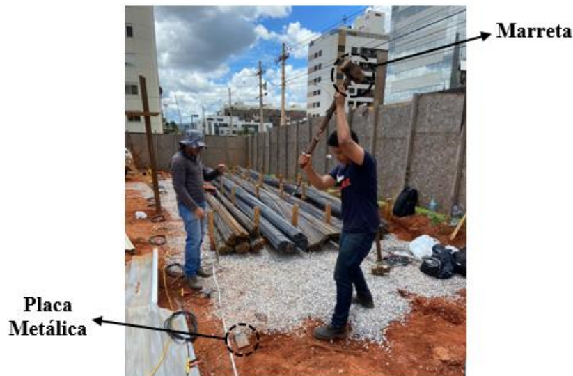
Figura 3.18: Geração das ondas sísmicas por meio de fonte ativa (marreta + placa metálica)
