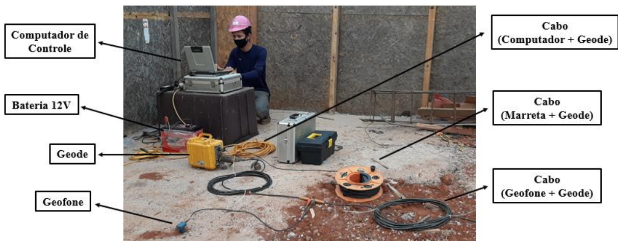
Figura 3.17: Disposição dos geofones na linha sísmica de campo
