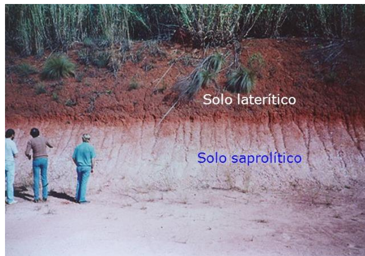
Figura 2.1. Perfil de solo com ocorrência de solos lateríticos e saprolítico (Nogami e Villibor, 1995)
