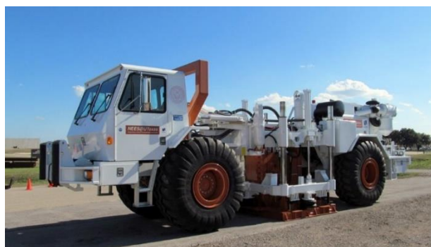
Figura 2.27: Exemplo de caminhão tipo Vibroseis® utilizado em levantamentos sísmicos (Mitnick, 2018)
