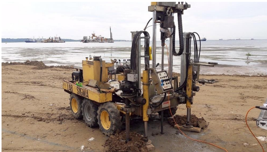
Figura 2.18: Ensaio de penetração de cone (Marc, 2021)
