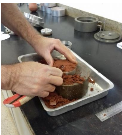
Figura 3.27: Cravação do molde metálico na amostra de solo
