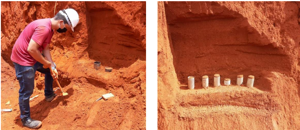
Figura 3.8: Coleta de amostras indeformadas de solo em cilindros metálicos para realização do ensaio triaxial convencional
