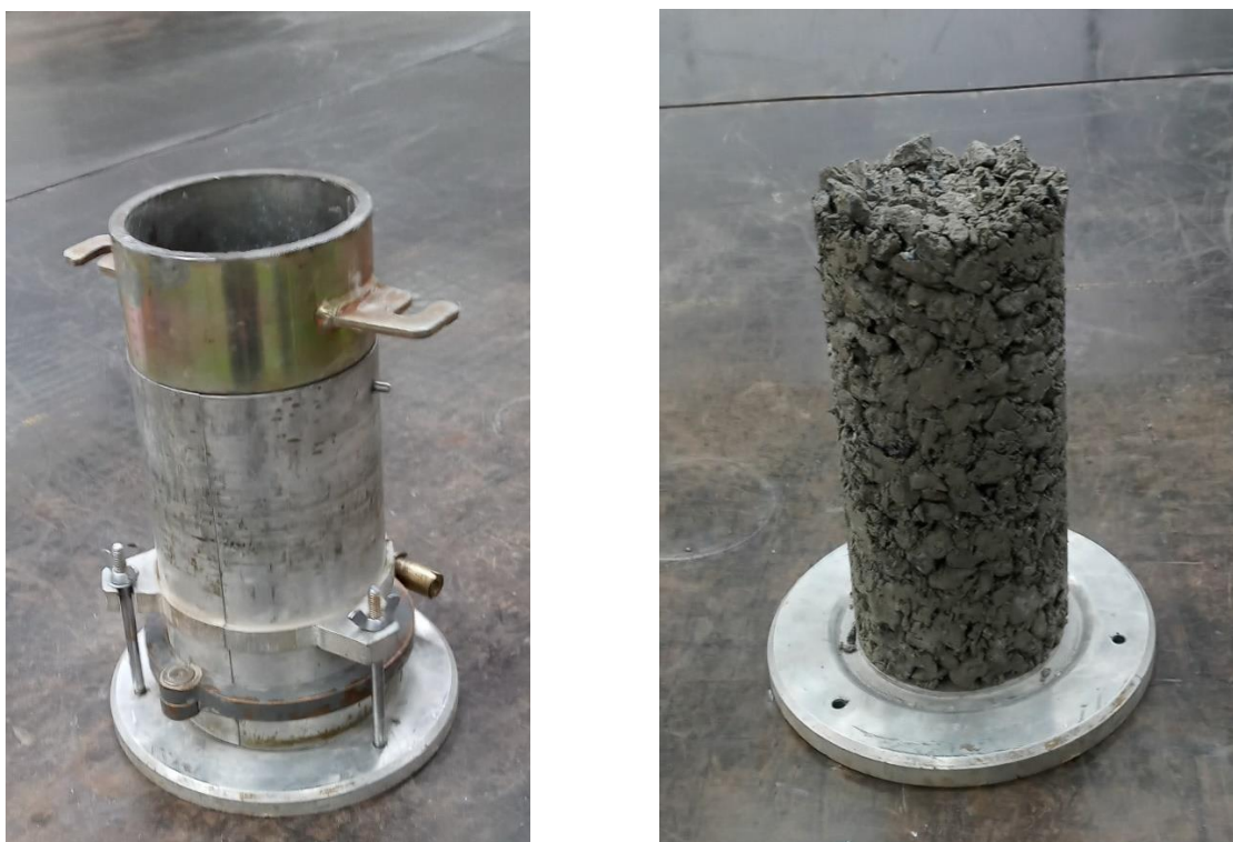
Figura 3.8 – Cilindro tripartido usado na moldagem e corpo de prova de BGTC
