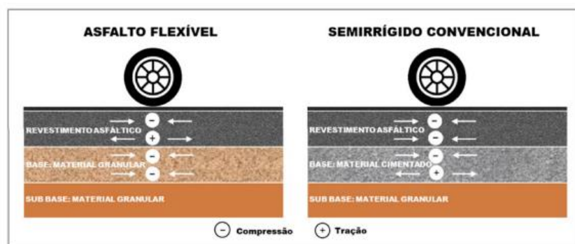
Figura 2.3 – Tração nas fibras inferiores da BGTC ( Balbo, 2007, adaptado por Prado, 2018)
