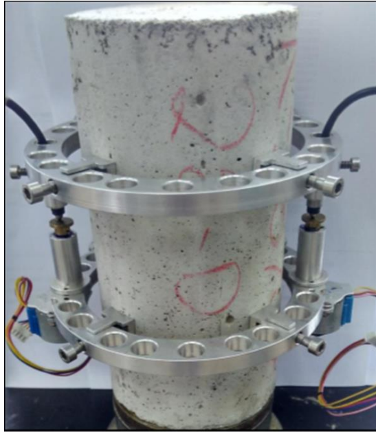
Figura 3.9 – Sistema de medição de deslocamento no terço médio (Norma DNIT 181/2018-ME)
