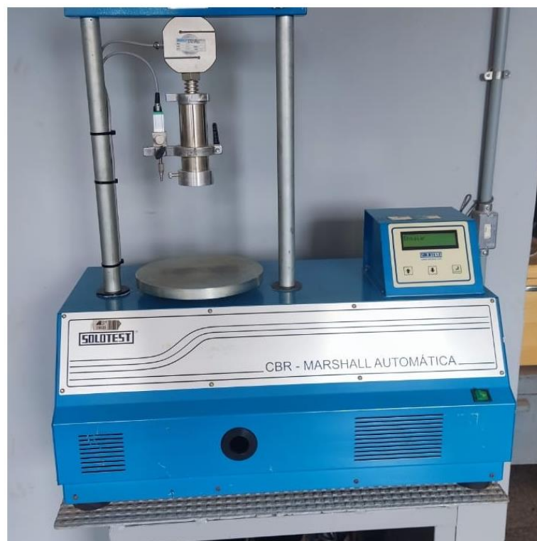
Figura 3.10 – Prensa utilizada no ensaio de tração indireta
