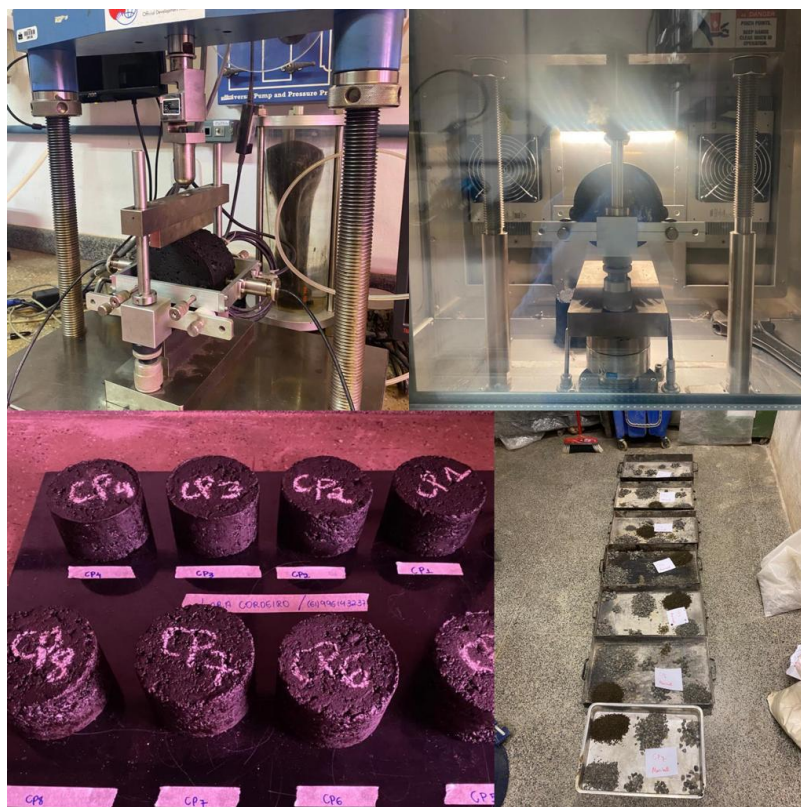
Figura 4-11 – Etapas do ensaio de Módulo de Resiliência.
