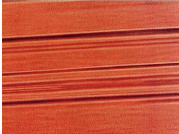
**Figura 4** – Transição gás-líquido obtida por meio da aplicação de campo magnético em amostra básica de EDL-MF à base maguemita com 12 nm de diâmetro.<sup>47</sup> A transição foi observada com um microscópio óptico em campo magnético com módulo ligeiramente inferior a 0,1 T.
