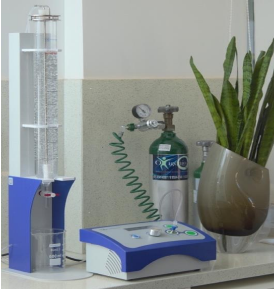
Figura 1 Gerador de ozônio e coluna de água.
