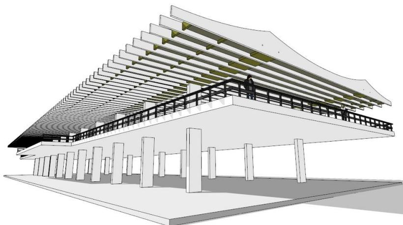
Figura 3: Detalhe dos pilares, vigas mestras e vigas transversais (objeto de estudo).
