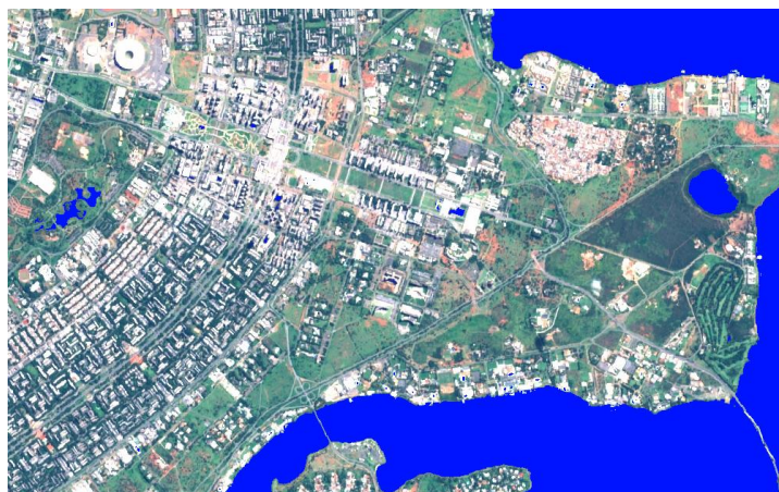
Figura 18 – Índice NDWI com discretização, em azul, de corpos hídricos no limiar de 0.1, na cena de 13/05/2019
