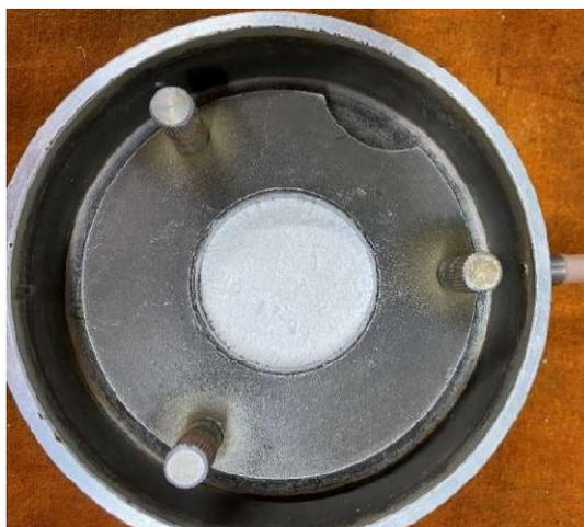
Figura 4.2- Preparação do oedômetro com caulinita
