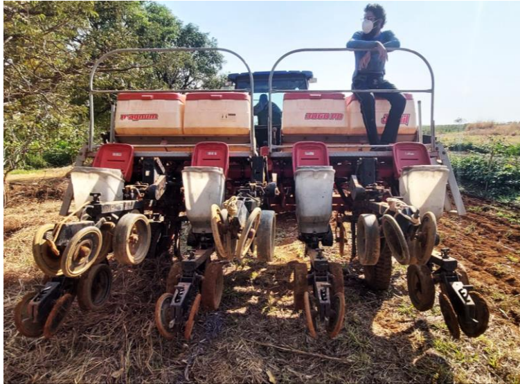
Figura 30 - Plantadeira preparada para plantio de guandu e abertura de sulcos intercalados para posterior semeadura manual de capins.
