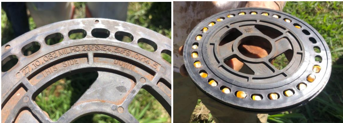
Figuras 20 e 21 - Disco de 28 furos para semeadura de milho.
