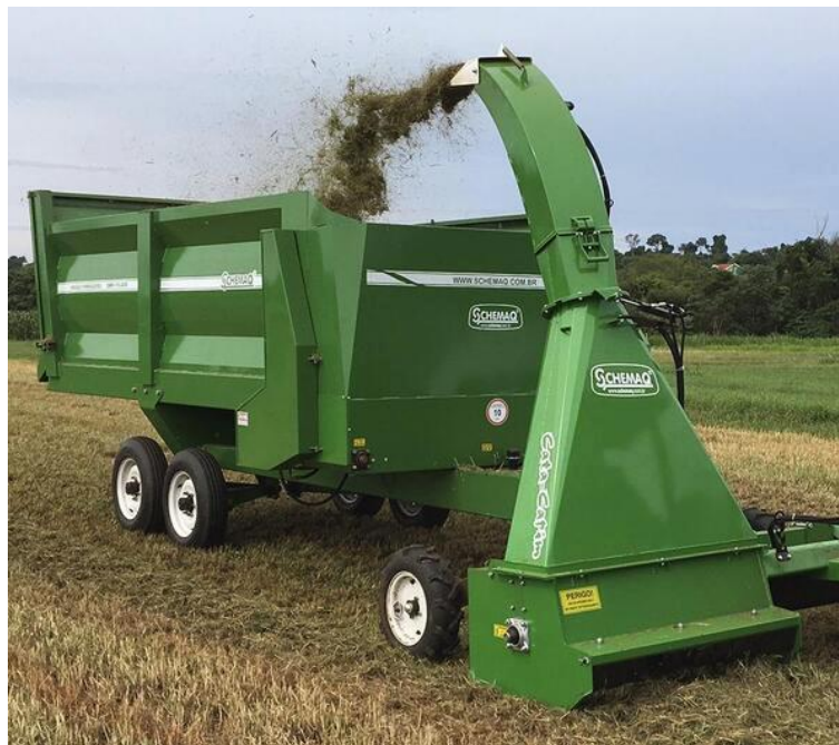
Figura 8 - Cata capim, implemento que roça a lavoura, processa a palhada e distribui com direcionamento.
