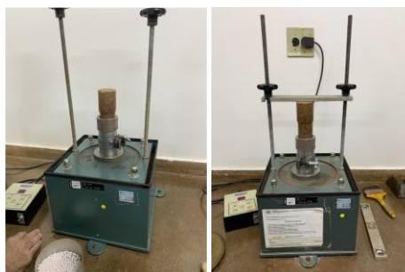
Figura 3.10. Determinação do Índice de Vazios Mínimo, dos poliedros.
