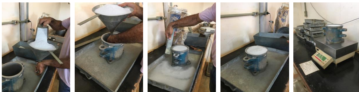
Figura 3.7. Determinação do índice de Vazios Máximo.
