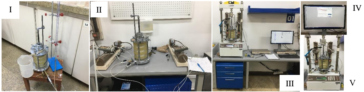
Figura 3.27. Etapas do Ensaio de Compressão Triaxial; I) Saturação por percolação, II) Saturação por contrapressão, III) Consolidação, IV) Programação do ensaio e registro de dados do Cisalhamento e V) Cisalhamento.
