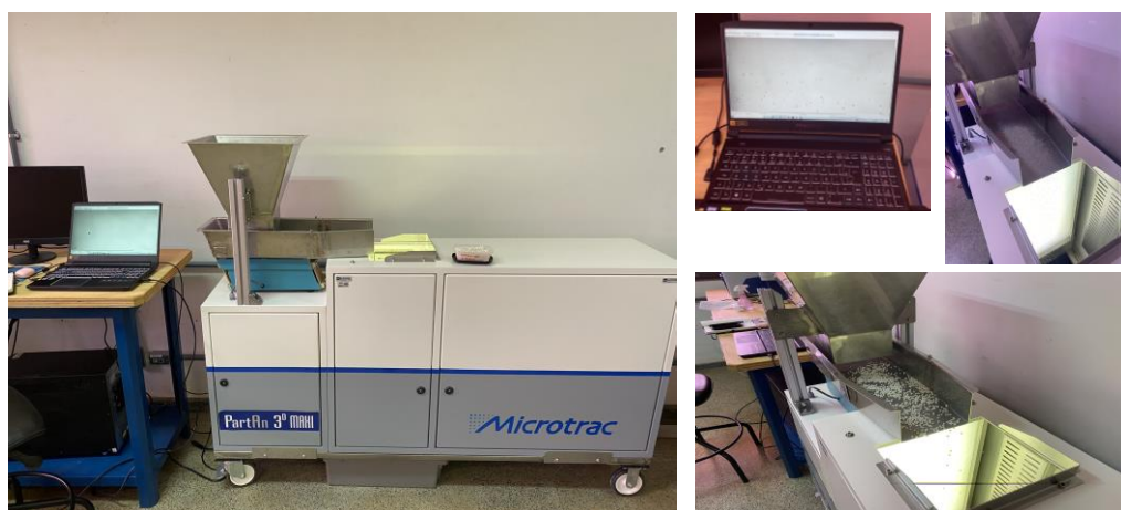
Figura 3.14. Caracterização das partículas com o PartAn 3D.
