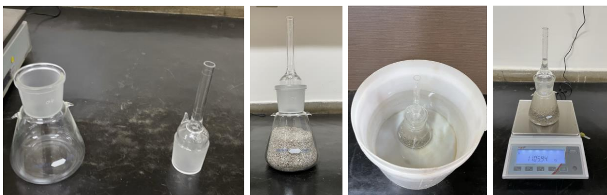
Figura 3.5. Picnômetro com Areia Padrão.
