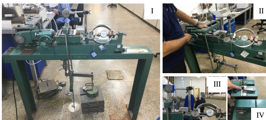
Figura 3.23. Cisalhamento Direto: I) Equipamento em ensaio, II) Regulagem para cisalhamento, III) Leitura de deslocamento vertical e horizontal e IV) Ajuste da velocidade.
