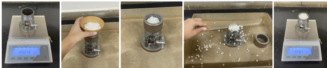
Figura 3.9. Determinação do Índice de Vazios Máximo, dos poliedros.
