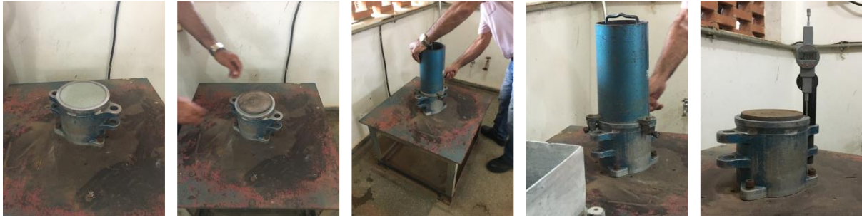
Figura 3.8. Determinação do Índice de Vazios Mínimo.
